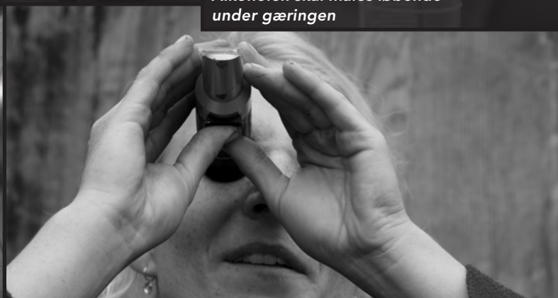
Måling af sukkerindhold i mosten med refraktometer
